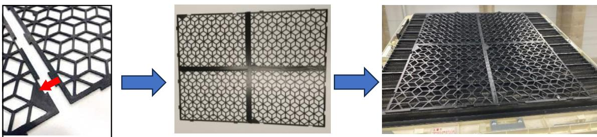
\* フィルターの清掃時、カバーを下すとエアエコ®が落ちることを防ぐために、3cm程度にカットした両面テープをエアエコ®の四隅に貼り、フィルターと貼り付けることで固定することができます。
